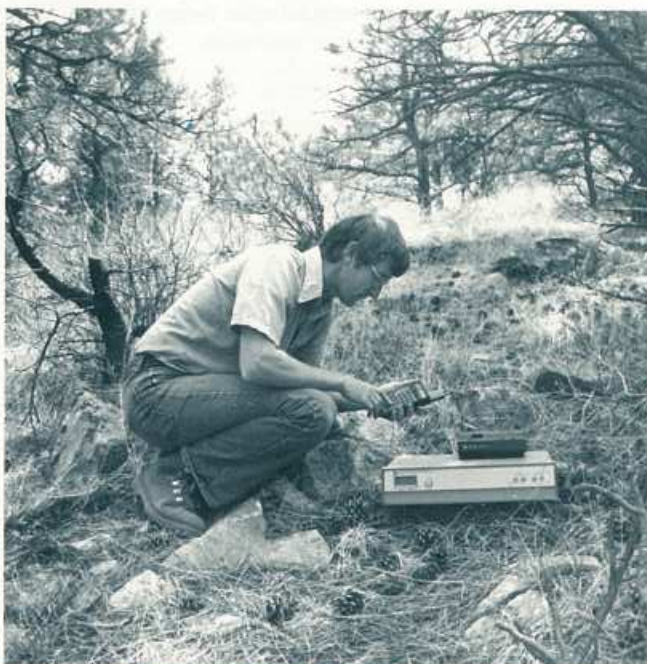
Met de 3421A meet men grondtemperatuur op 30 plaatsen om na te gaan hoe de houtkap de sterfte onder nieuwe aanplant beïnvloedt.
