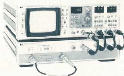
De HP 8754A netwerk analyzer (met uitbreiding H26), hier afgebeeld met de bijpassende S-parameter testset. Geschikt voor metingen met frequentiezwaaai van 4 MHz - 2,6 GHz.
